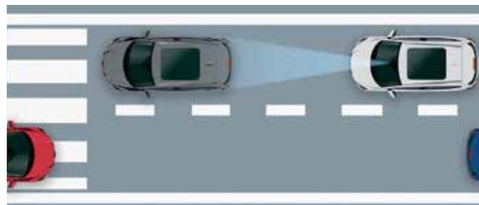
**1 :** À une vitesse comprise entre 5 et 32 km/h en ville, ce système minimise les risques de collision en surveillant en permanence la distance qui vous sépare du véhicule qui vous précède.
