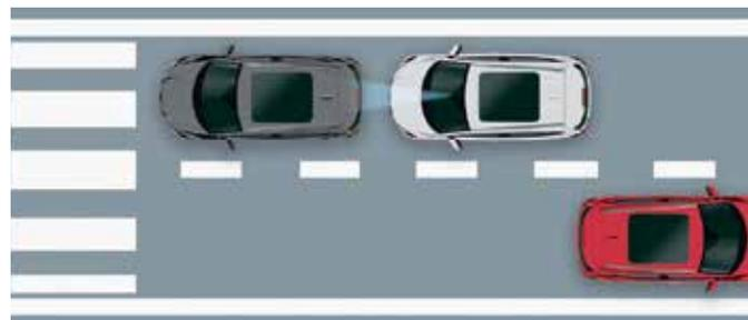
**3 :** En l'absence de réaction de votre part et si une collision est imminente, le système actif de freinage en ville peut exercer automatiquement un freinage d'urgence pour réduire la vitesse le plus possible. Dans de bonnes conditions de conduite, ce système peut même éviter une collision.
