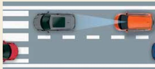
**1 :** À une vitesse comprise entre 5 et 32 km/h en ville, ce système minimise les risques de collision en surveillant en permanence la distance qui vous sépare du véhicule qui vous précède.
