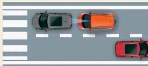
**3 :** En l'absence de réaction de votre part et si une collision est imminente, le système actif de freinage en ville peut exercer automatiquement un freinage d'urgence pour réduire la vitesse le plus possible. Dans de bonnes conditions de conduite, ce système peut même éviter une collision.
