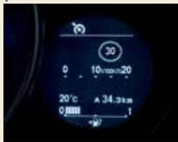
Le système TSR identifie les panneaux de signalisation jusqu'à une distance de 100 m. Il vous transmet ensuite les informations via l'affichage multi-information (MID), lui-même capable d'afficher simultanément deux panneaux.
